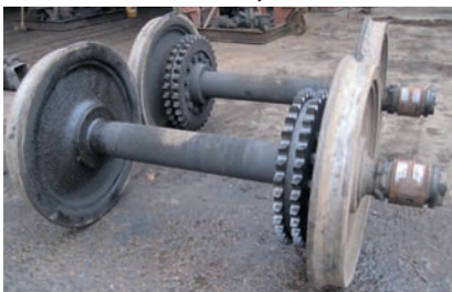
Essieux reprofilés avec fiches suiveuses Turned axles
