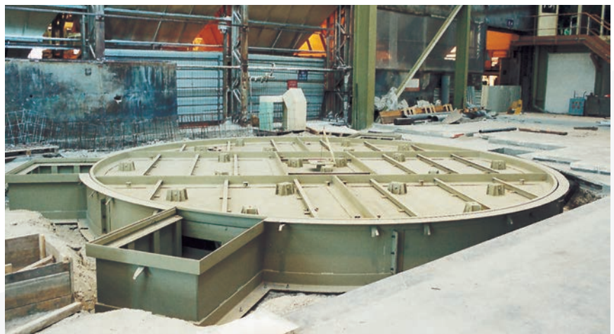
Plaque tournante diamètre : 7,5 m - charge 16 T en tous points - motorisation électrique rotation 360° Turntable Diameter 7,5 m - 16 T load at all points - electric motor driven revolution 360°
