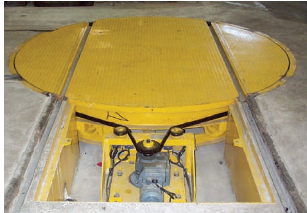
Plaque tournante motorisée charge 10 t, diamètre 2,6 mètres Motor driven turntable, load 10 t, diameter 2,6 meters
