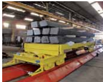
Chariot 35 tonnes en test de charge sur voie de grue.
