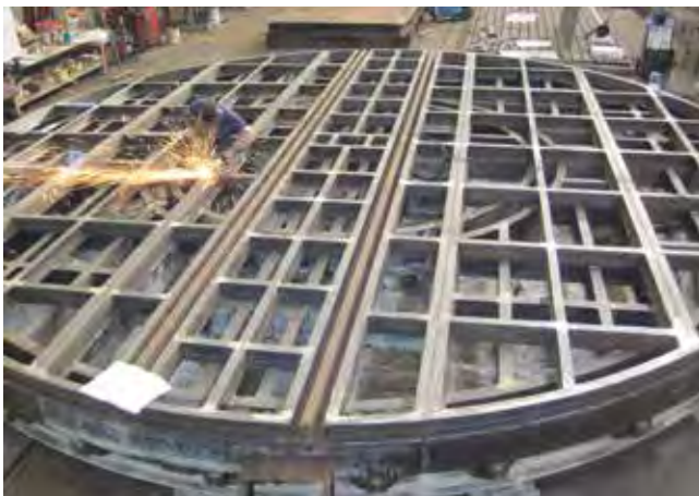
Plaque tournante motorisée charge 60 t, diamètre 8,5 mètres, en cours de fabrication Motor driven turntable load 60 t, diameter 8,5 meters, being manufactured
