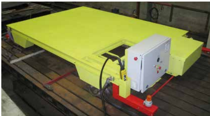
Chariot électrique sur batteries 6 T Motorized trolley, battery powered, load 6 T
