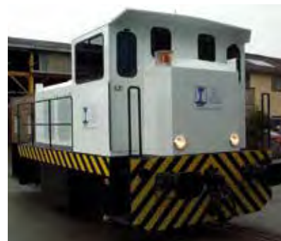
Locotracteur VN 44 hydrostatique Hydrostatic locomotive VN 44
