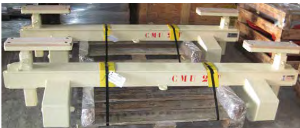
Lorry spécifique 2 T position de charge variable - hauteur de pose réglable Specific lorry 2 T with variable load position - adjustable construction height
