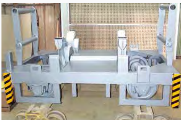
Chariot automoteur pour conteneurs secteur nucléaire 6 T Automotor truck for container for nuclear power, load 6 T
