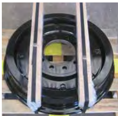
Roue 600 pour pelle rail-route hydraulique Wheel 600 for hydraulic rail-road machine
