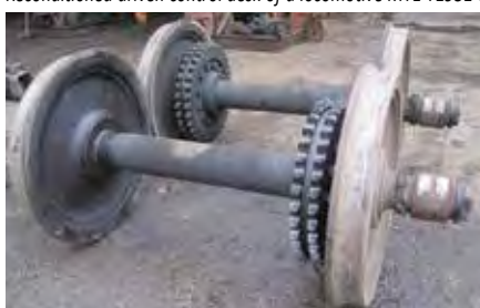
Essieux reprofilés avec fiches suiveuses Turned axles
