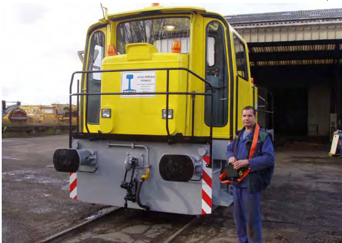
Locotracteur Moyse BN44 EE radiocommandé Remote controlled locomotive Moyse BN44 EE
