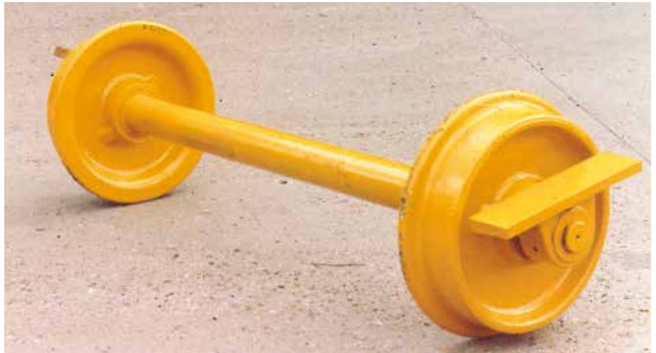
Essieu roue 300 M Voie 1440 charge : 5 t Axle wheel 300 M gauge 1440 load : 5 t
