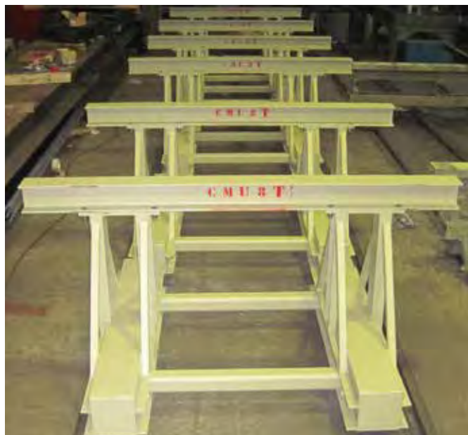
Chariot manuel 8 T, cabine de peinture Manuel trolley load 8 T, paint booth
